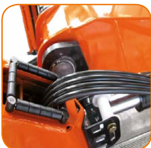
Innenliegende Schlauchführung, guter Schutz für die Schläuche. Internal hose routing, good protection for hoses.
