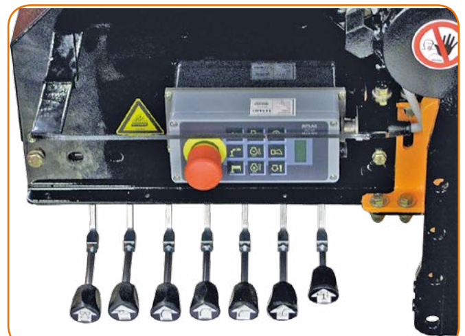
EL - HMS Handhebelsteuerung, Optional EL -HMS Hand lever control, optional
